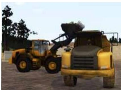
Типовое задание №5. Произвести загрузку самосвала используя схему работы погрузчика «с разворотом на 180°»
