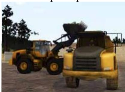
Типовое задание №4. Произвести загрузку самосвала используя схему работы погрузчика «челночным способом»
