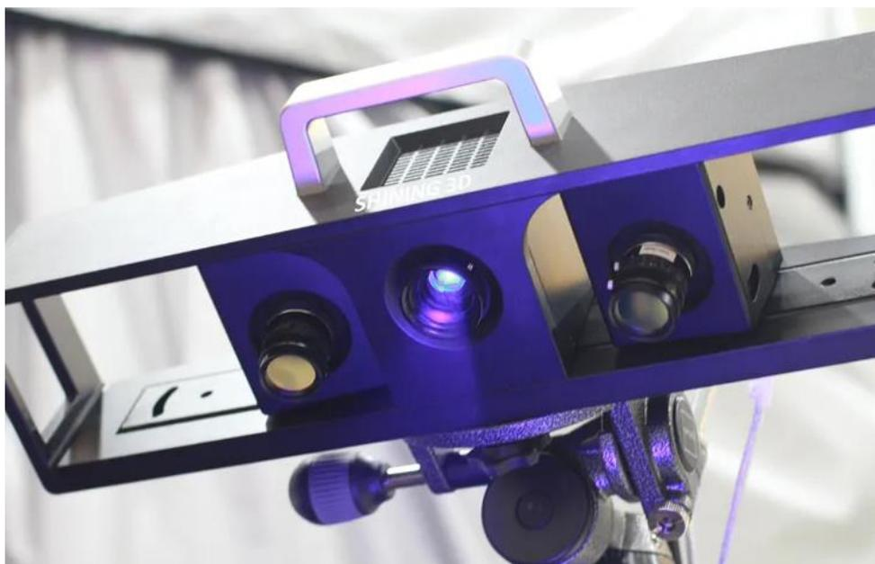
Рисунок 2 – Оптический сканер
