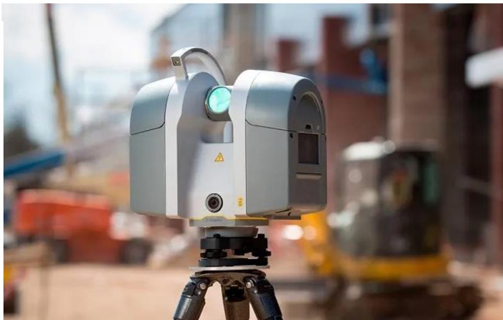
Рисунок 1 – Лазерный 3D - сканер
