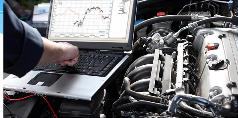
Причин для проведения компьютерного диагностирования силовой части машины может быть много: трудности с запуском, повышение расхода топлива, периодическое перегревание мотора, изменение оборотов холостого хода двигателя, значительные потери мощности, появление сторонних вибрации, звуков, причем не только при движении. Компьютерная диагностика двигателя автомобиля дает возможность проверки уровня компрессии мотора и систем электроснабжения, впрыска.
