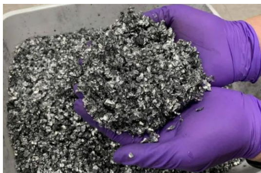
Рисунок 5 – Переработанные компоненты батареи
