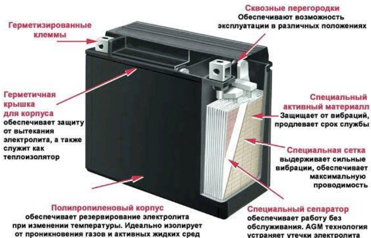
Устройство аккумулятора AGM
